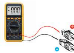
Figura 5.16 Medição por multimetro
